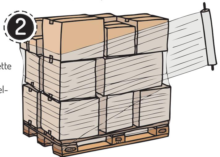
Die Kartons müssen in geeigneter Weise fest mit der Palette verbunden sein. Je nach Kartons entweder per Zurrband (bei gleichen Kartongrößen - Abbildung 1) oder per Wickelfolie (bei verschiedenen Kartongrößen - Abbildung 2).
